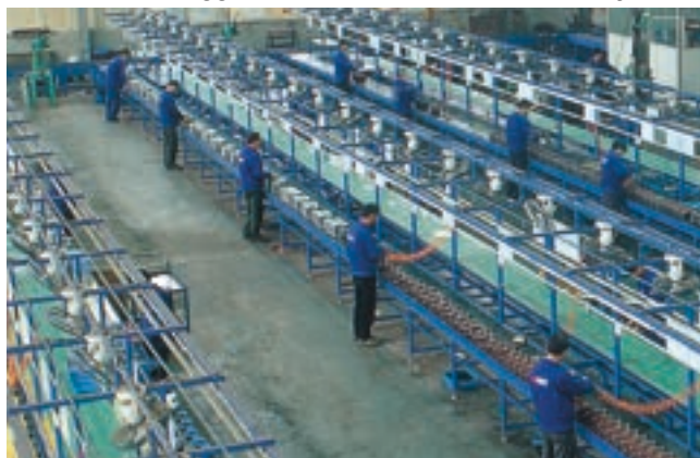
Linea assemblaggio riduttori - Gear units assembly line
