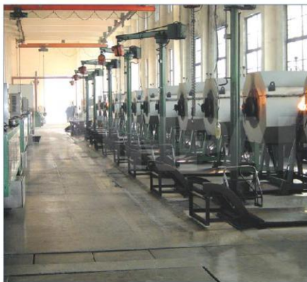
转炉 / 用于销轴热处理 Rotatory furnace / Used for pin heat treatment
